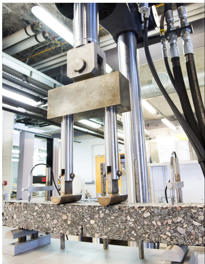
Essai de flexion 4 points
